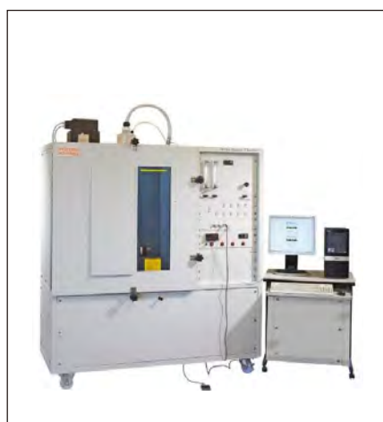
FTT NBS烟密度箱 (测量纺织品材料完全燃烧 后释放的烟雾释放情况)
