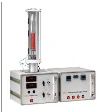
FTT氧指数仪/高温氧指数仪 (测量纺织品的临界燃烧氧指数， 获得纺织品燃烧所需的氧浓度)
