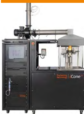
FTT icone2+ 锥形量热仪 (测量大片纺织品的热释放， 模拟真实燃烧环境)
