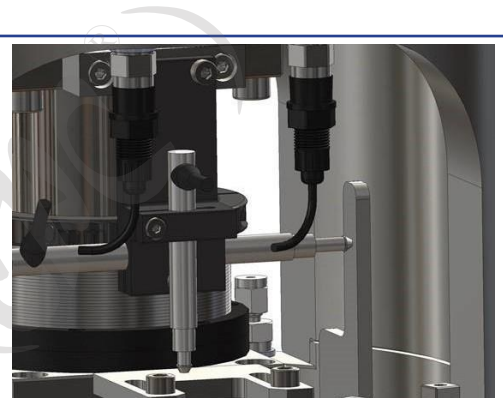
图 8 安装于顶帽上的局部 LVDT
