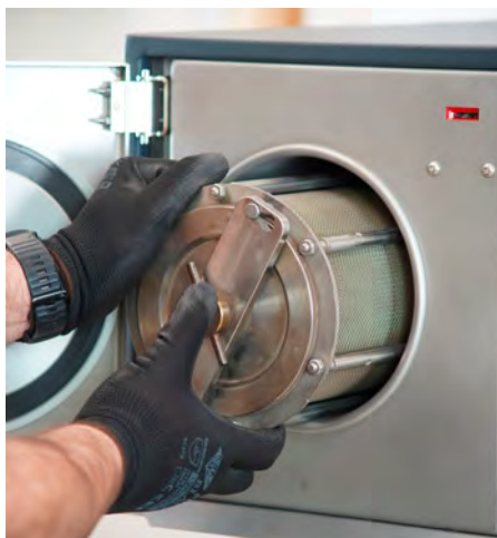
将洗涤滚筒放入机器中
